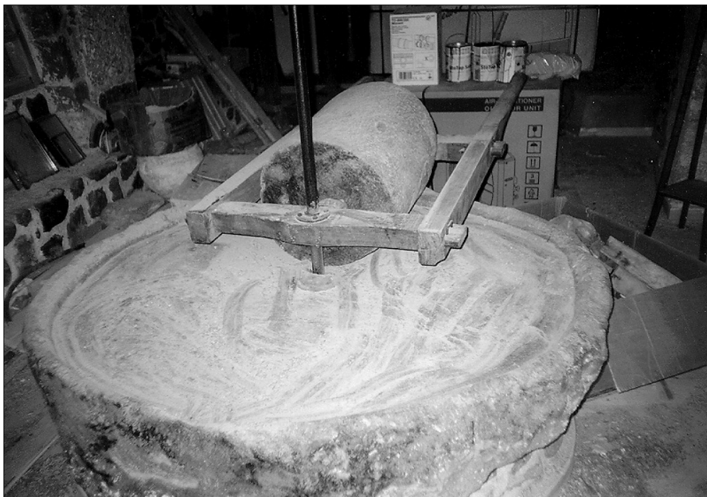
Λιοτρίδι Ν. Μαστρογιάννη. Πλάκα - Κυλινδρόμυλος
