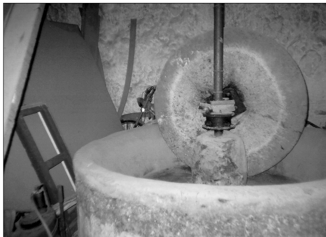
Λιστρίδι Νίκου Κάρη. Η πλάκα και ο κυλινδρόμυλος
