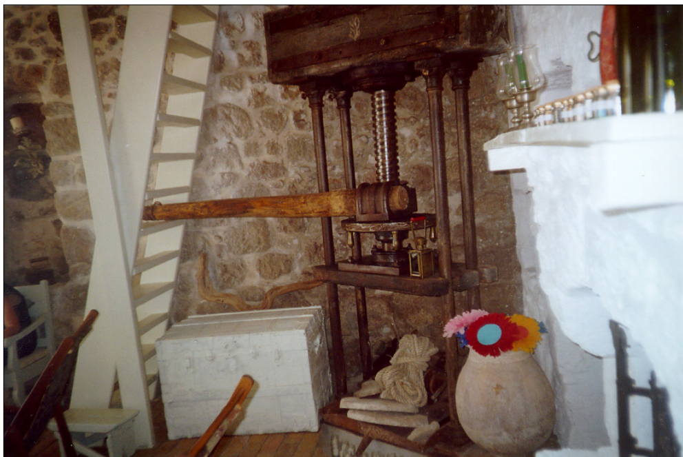
Νικειά. Λιοτριδί Γιώργου Μίχαλου. Η σισφικτική μηχανή με τη μανέλλα
