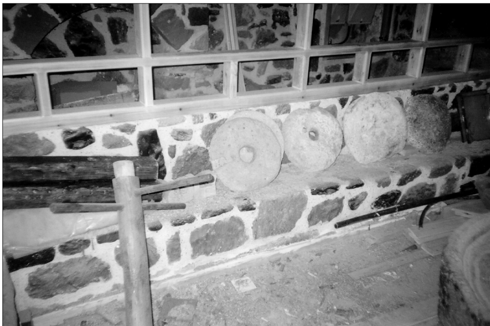
Εσωτερικό του λιωτρίδιού. Χειροκίνητες μυλόπετρες
