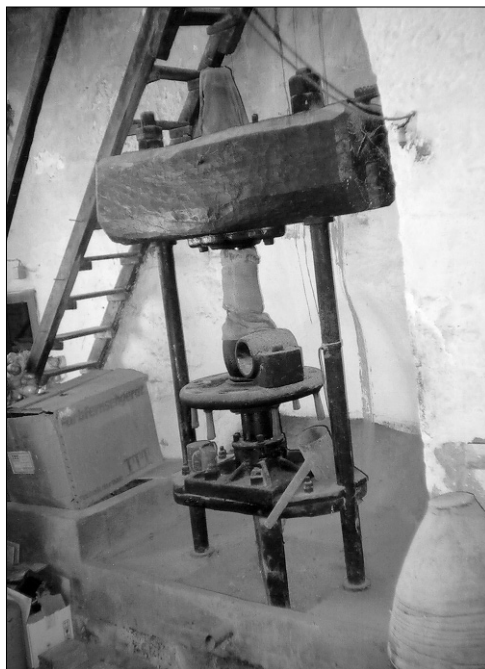
Λιοτρίδι Νίκου Κάρη. Μεταλλικό πιεστήριο
