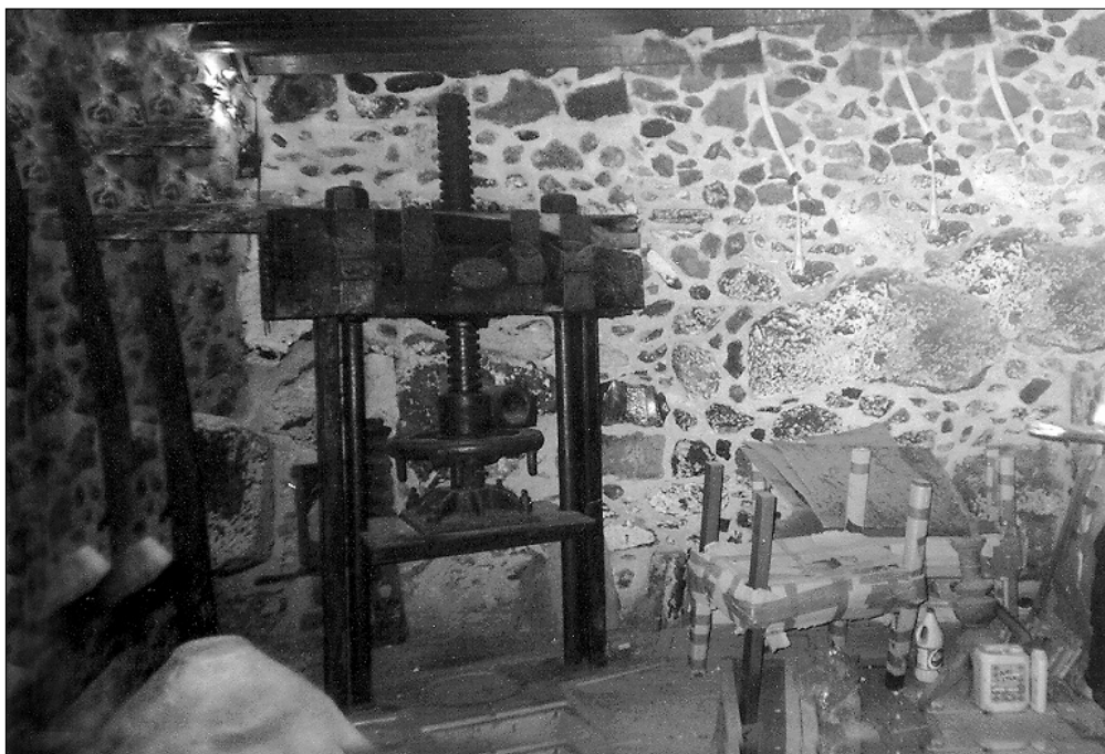
Λιοτρίδι Μαστρογιάννη. Μεταλλικό πιεστήριο.
