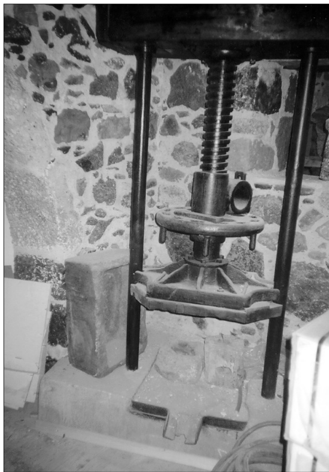
Λιοτρίδι Μαστρογιάννη. Μεταλλικό πιεστήριο
